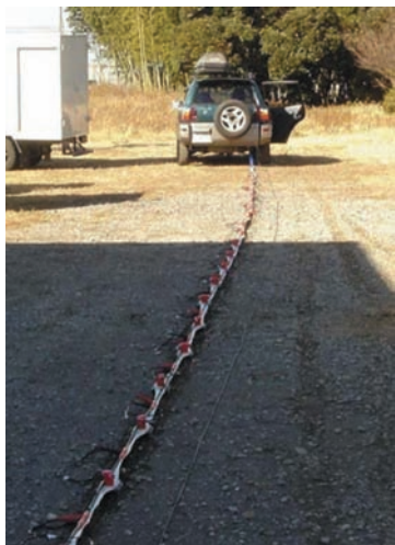
Rys. 3. Taśmowa konstrukcja strimera sejsmicznego LS-1 produkcji Geostuff [24]
