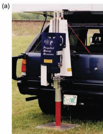
Rys. 5. Przykładowe kafary: Propped Energy Generator produkcji R.T Clark na podstawie [33] – a, ESS100 HM produkcji GISCO na podstawie [31] – b
