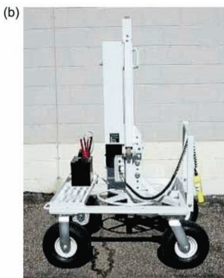
Rys. 5. Przykładowe kafary: Propped Energy Generator produkcji R.T Clark na podstawie [33] – a, ESS100 HM produkcji GISCO na podstawie [31] – b
